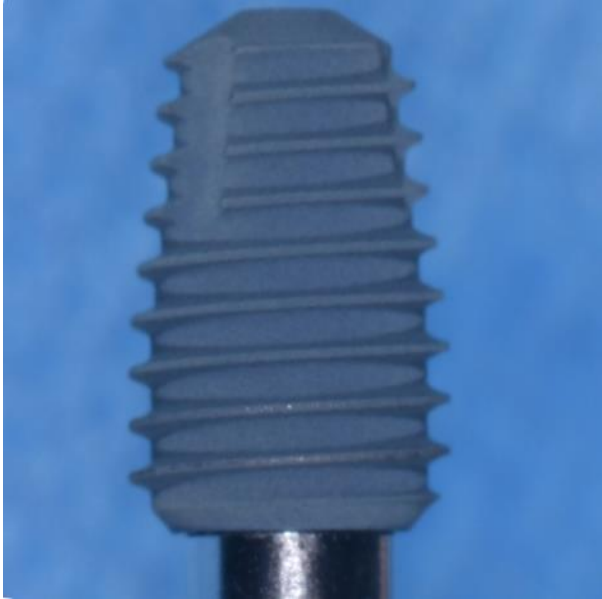
Resim 2: Osteoblast aktivasyonu elde etmek ve osseointegrasyonu hızlandırmak amacıyla hidro-termal yöntem ile kalsiyum iyonu emdirilmiş yeni nesil bir implant yüzeyi. Yüzey renginin mavi renkte olması asit artışı olmadığının bir göstergesidir.
