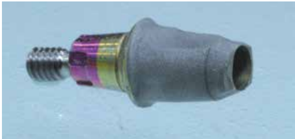
Resim 5 Titanyum dayanağın yapışma yüzeyinin kumlama ile pürüzlendirme işleminden sonraki görünümü
